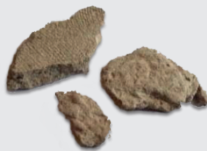
Rohrisolierungen auf Gips-Basis
