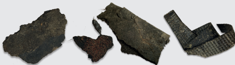
Dachbahnen, bituminöses Material (Asbest, KMF, PAK)
